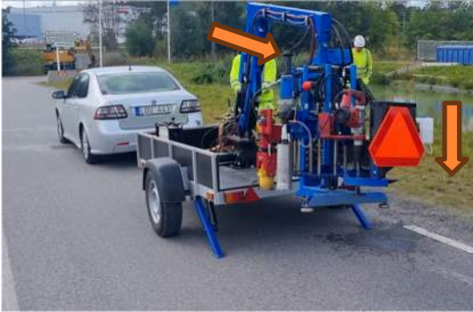
Figur 3.2C Provtagningsutrustningen lyfts ner på asfalten
