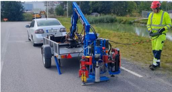
Figur 3.2D Borrverktyget är framroterat, provtagning kan påbörjas
