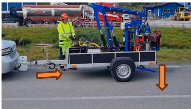
Figur 3.2A Teleskoperande dragstång samt nedfällning av stödben
