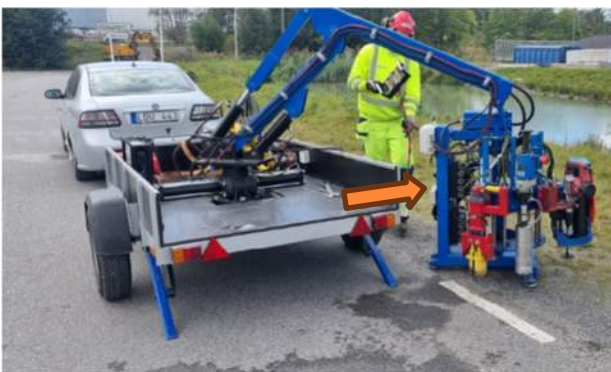
Figur 3.2E Lyftarmens räckvidd möjliggör provtagning utmed hela körfältets bredd
