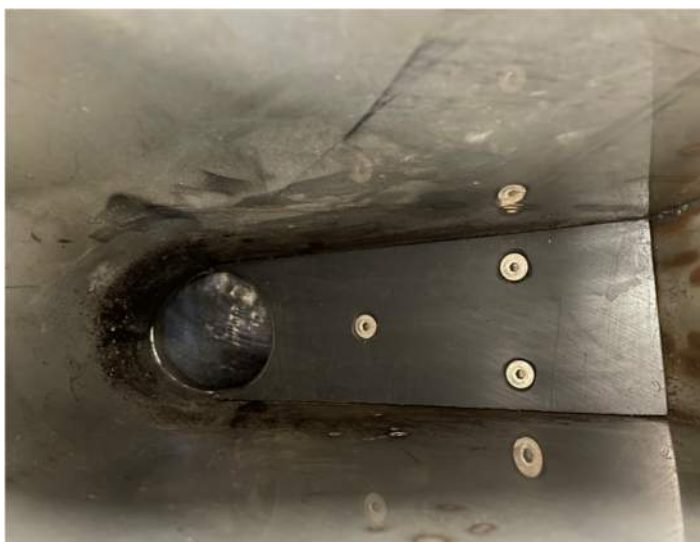
Figur 2.2B Sluttande plan belagt med plast med grafit inuti behållaren.
