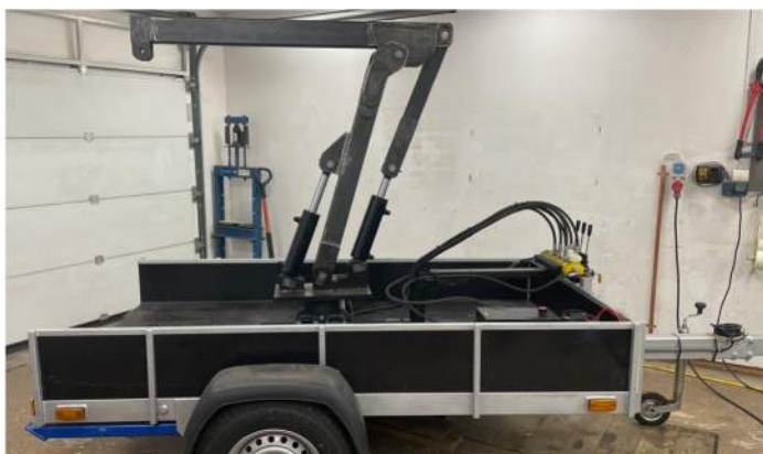
Figur 2.4A Tillverkad bärare med lyftarm
