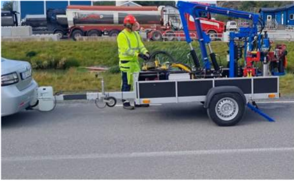
Figur 3.2B Släpvagn placerad och stödben nedfällda
