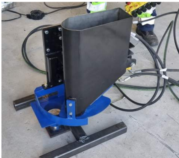
Figur 2.2A Ny behållare för lagningsmassa (testversion)
