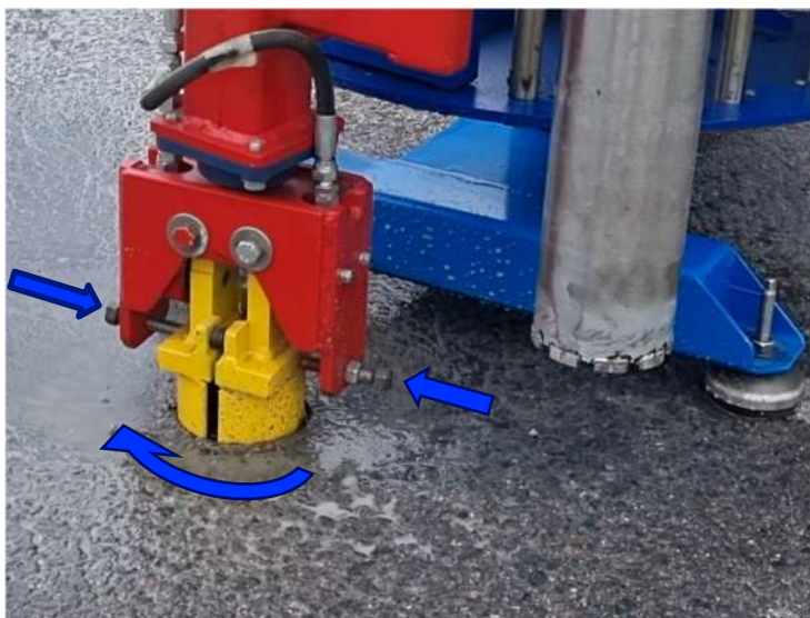
Figur 3.4A Verktygets halvor kläms ihop runt provkroppen och vrider loss den från underlaget
